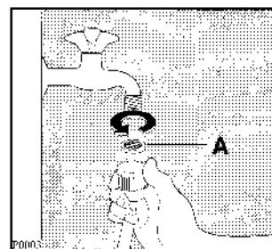
Подключите машину к водопроводному крану. Подключение должен выполнить специалист, используя переходник. В продаже есть разные типы переходников.
